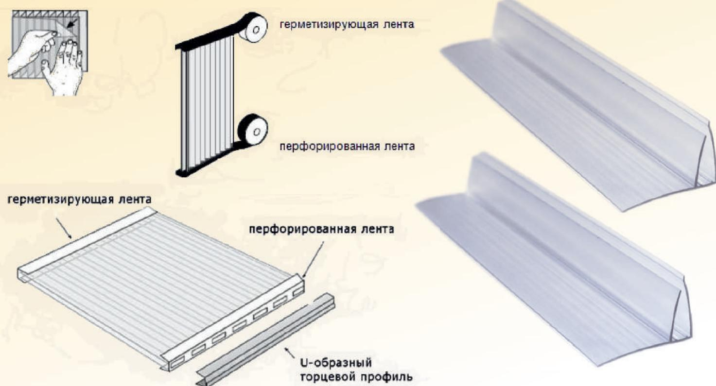
Края, заклеенные лентой, обязательно закрываются торцевыми профилями (если край панели не уходит в пазы или другие профили). В профилях, которые крепятся к нижнему краю листа, необходимо просверлить дренажные отверстия диаметром 2-3 мм с шагом 300 мм
