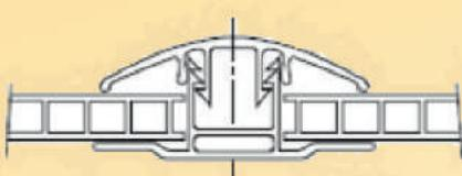
Данный профиль удобен для соединения длинных листов на скате крыши или в арочных конструкциях.
